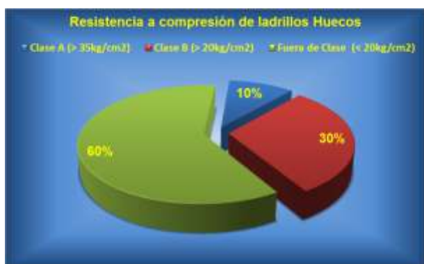
Figura 2 - Resultados de la resistencia a la compresión de ladrillos huecos de las diferentes fábricas estudiadas.
